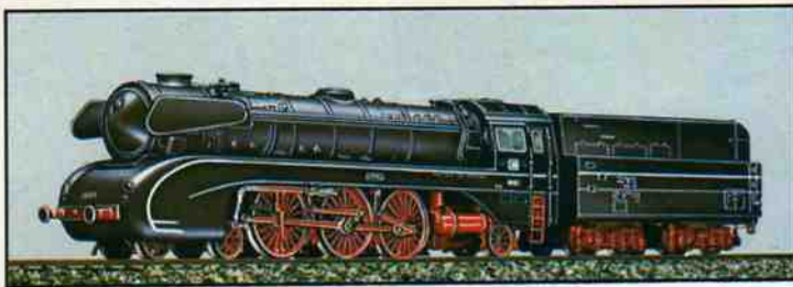
203016LG Locomotiva a vapore con tender 2-C-1 BR10 delle ferrovie tedesche D.B.
