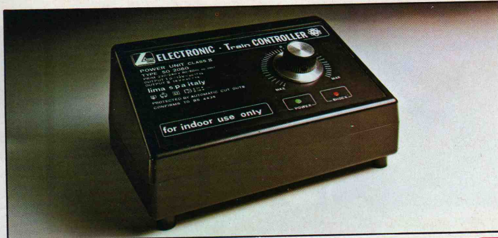
502060 Trasformatore per due treni, scambi ed accessori elettrici. Alimentazione 220 V-50/60 Hz. Tensione regolata elettronicamente per l'uscita in corrente continua da 0-12 V = 7,5 V.A. NEW
