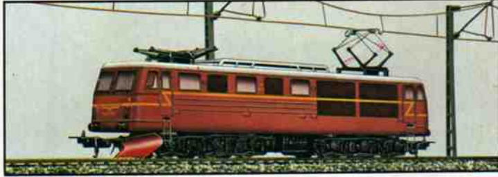
208130LG Locomotiva elettrica Co' Co', tipo EL14 delle N.S.B.
